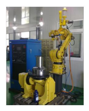
等离子堆焊存在的主要问题及发展前景:在系统控制方面,由于等离子堆焊工艺参数比较复杂,因此等离子焊接设备中要控制的对象比较多,主要包括转移弧整流电源、高频振荡电源、气量、冷却水、堆焊数控机床、送粉器和摆动器等,其中任何一个参数的变化都可能影响堆焊层的质量和性能。刚开始采用手动控制,堆焊质量与操作者有非常大的关系。后来发展到使用继电器逻辑电路及二极管矩阵逻辑电路作为程控系统,系统集成程度不高,给维修或因加工对象改变而修改工艺程序带来巨大的不便。等离子粉末堆焊后基体材料和堆焊材料之间形成融合界面,结合强度高,堆焊层组织致密。黑龙江热丝等离子堆焊机
