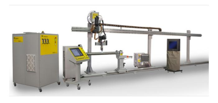
为啥要用等离子堆焊?制造新零件(等离子弧3D打印):等离子弧3D打印是通过直接在基板上或者在金属基体上堆焊合金材料以制造具有综合性能的机器零部件。这种零部件由于采用等离子弧粉末冶金制造,可以预先设定在不同部位打印不同性能的合金材料,能够满足新部件的许多特殊功能设计要求,充分挖掘合金材料的巨大潜力。例如,水轮机的叶片,基体材料为碳素钢,在可能发生气蚀部分(多在叶片背面下半段)堆焊一层不锈钢,使之成为耐气蚀的双金属叶片;在金属模具的制造中,基体要求强韧,选用价格相对便宜的碳钢、低合金钢制造,而刃模要求硬度高、耐磨,采用耐磨耐高温合金堆焊在模具刃模部位,能够大幅度延长模具的使用寿命。
