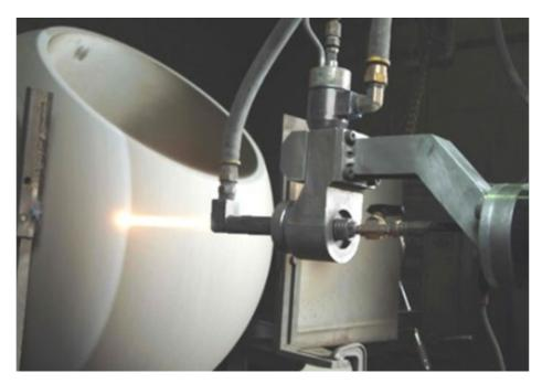
等离子堆焊机是应用离子弧为热源,将金属粉末与基体表面进行加热熔化,待冷却后凝合在一起的焊接技术。该类方法的应用,能够很好的提升零件表面的硬度,强化零件性能。可用于堆焊的金属主要包含以下几类: 1、珠光体钢堆焊金属:将该类金属应用于等离子堆焊机中后,焊接完成后其合金焊接较好,具有较强的抗冲击能力,但是其硬度会比较低,多用于一些轴类机械零件的维修。2、奥氏体钢堆焊金属:该类金属其冲击韧度、硬化等性能较好,缺点是比较容易有裂纹出现。在工业生产中,多用于修复零件磨损问题,常见如矿山料车、铁路道岔等。黑龙江热丝等离子堆焊机目前国内外所采用的等离子堆焊粉末主要有自熔性合金粉末和复合粉末两大类。
